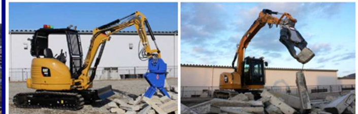
小型・大型無線重機 （屋内外の瓦礫等の除去）
