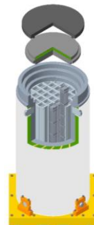
図2 乾式キャスクの構造
