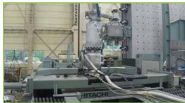
共振振動台での主蒸気逃がし安全弁性能確認試験
