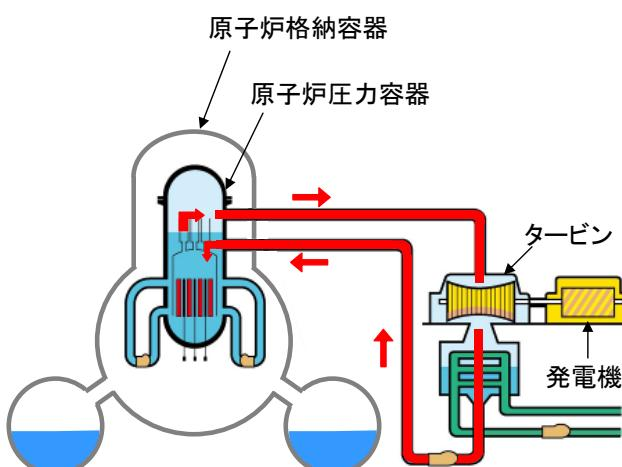
原子炉の中で蒸気を発生させ、それを直接タービンへ送る
