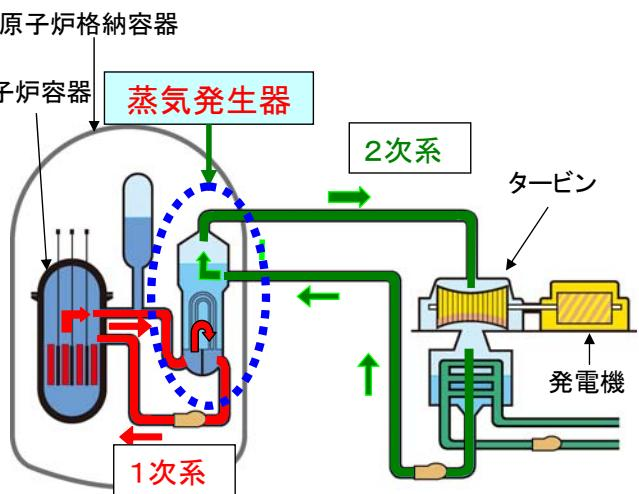
原子炉の中で発生した高温高圧の熱水を蒸気発生器へ送り、そこで2次系に流れている水を蒸気に変えてタービンへ送る
