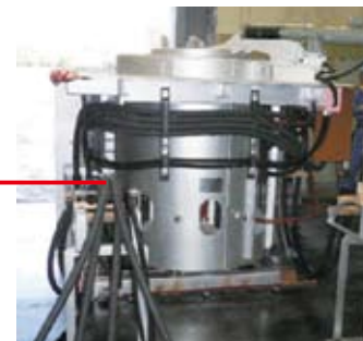
150kW 誘導加熱炉
