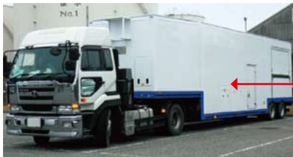
オンサイト式アスベスト溶融・ 無害化処理システム外観
