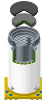
図2 乾式キャスクの構造
