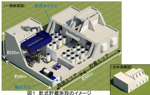
図1 乾式貯蔵施設のイメージ
