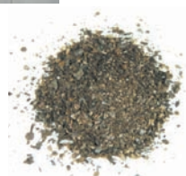
中間処理後、肥料、土壌改良材、セメント原料などに再利用します。 (写真は肥料原料)
