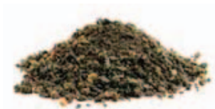
石炭火力発電所から 発生した石炭灰 (写真はクリンカアッシュ。クリン カアッシュはボイラ底部に落下し た灰の塊を粉砕したもの。)
