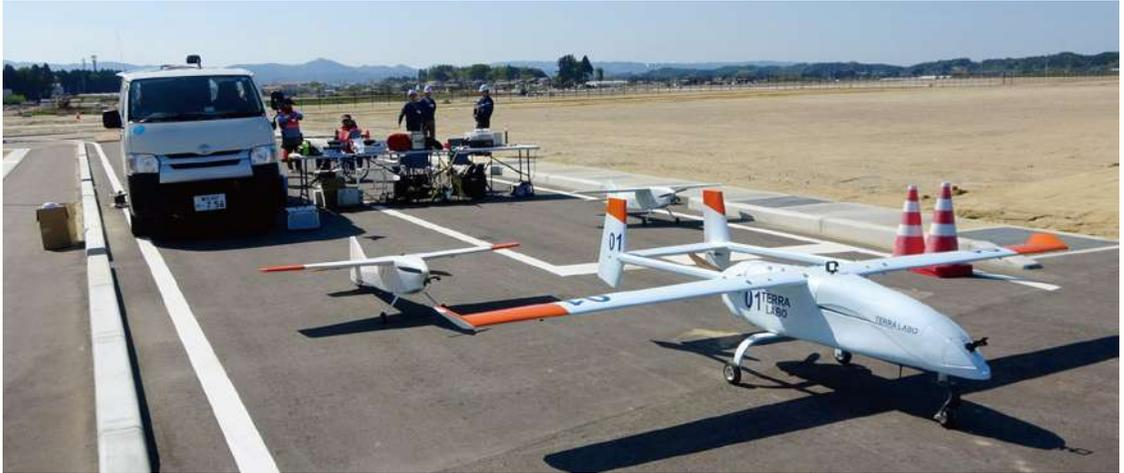
最新技術を駆使して開発が進む、固定翼ドローン。長時間の飛行が可能で、災害発生時の状況調査などで活躍が見込まれる 提供:テラ・ラボ
