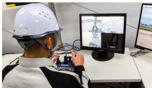
コントロール車の操作室(中型トラック荷台部分)
