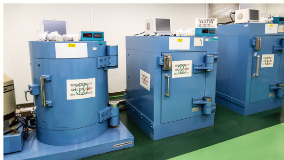
試料中の放射能を分析するゲルマニウム検出器型波高分析装置
