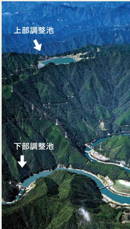
九州電力最大の揚水式発電所・小丸川発電所(30万kW×4基)で3号機のオーバーホールが進んでいます。揚水発電所は、電力需要が少ない時に下部調整池から上部調整池に水をくみ上げ、需要が多い時の発電用に蓄えておく、巨大な「蓄電池」です。
