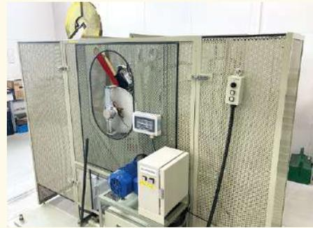
シャルピー衝撃試験機(写真)で試験片に衝撃を与え鋼材のねばり強さを確認
