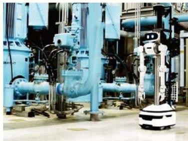
自律移動で点検作業を行うロボット 提供: 東北電力
