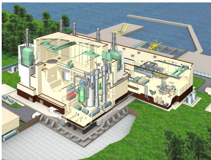
ナトリウム冷却高速増殖炉の概念 (出典：日本原子力発電株式会社)
