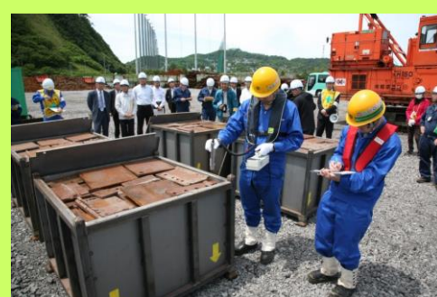
<金属の表面線量率測定>
