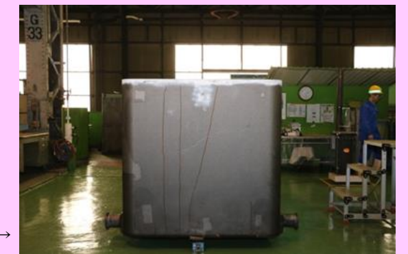
←発生した金属くず（粗加工後の切粉）の放射線測定
