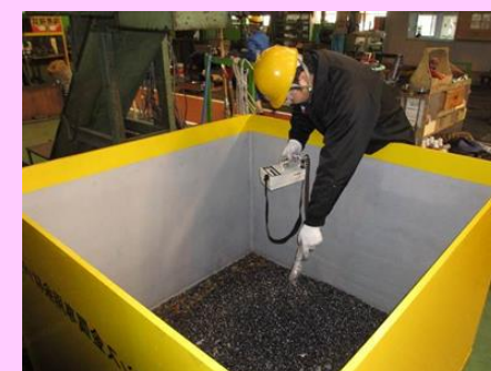
←発生した金属くず（粗加工後の切粉）の放射線測定
