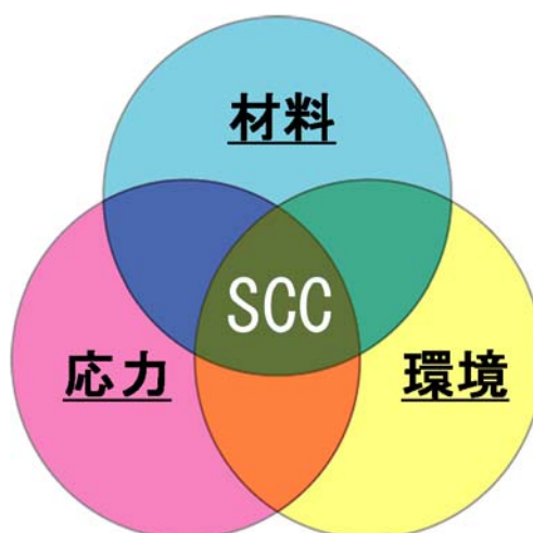
図 3.2.1 (2)-1 応力腐食割れの 3 因子と発生条件
