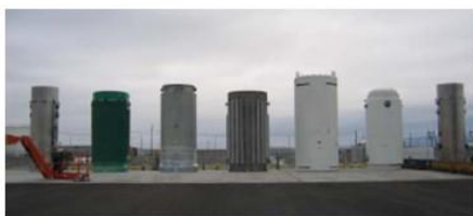
例：米国・アイダホ国立研究所で研究用として貯蔵されている乾式キャスク
