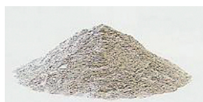
石炭火力発電所から 発生した石炭灰 (フライアッシュ)
