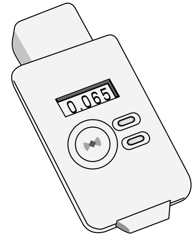
CsI シンチレーション式 (主に低線量の測定)
