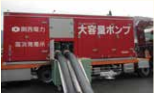
大容量ポンプ（関西電力）
