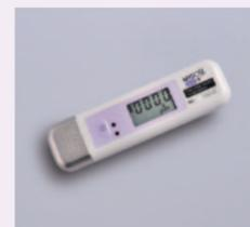
③個人の被ばく線量を調べる電子式線量計
