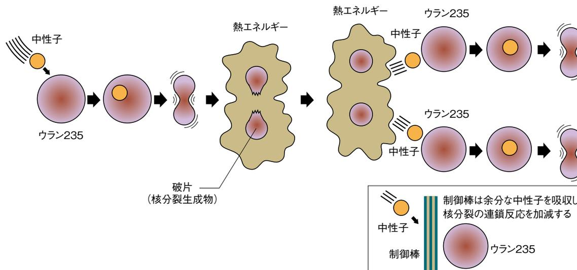
この時、制御棒等を調節して、発生した中性子 2～3 個のうちの 1 個を次の核分裂のためのウラン 235 に吸収させ、残りの中性子を制御棒に吸収させるように制御すれば、中性子の数が一定に保たれ、単位時間当たりにかかる核分裂反応（連鎖反応）を一定の状態（臨界状態）にすることができる。もしこれ以上の中性子をウラン 235 に吸収させるような状態に制御すると、核分裂数は増加し、出力は上昇し続ける（臨界超過）。また逆に、これ以下の状態にすれば核分裂数は減少し、出力も減少し続ける（臨界未満）。このように制御棒等を調節して臨界未満～臨界～臨界超過の状態を調節することによって、出力がコントロールできるわけである。
