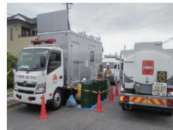
<タンクローリーから電源車への燃料補給の様子>
