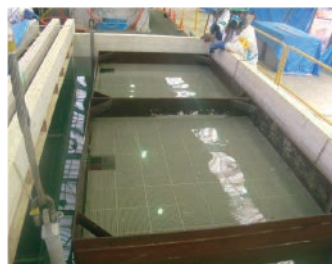
脱硝触媒の化学洗浄の様子 提供：株式会社JERA
