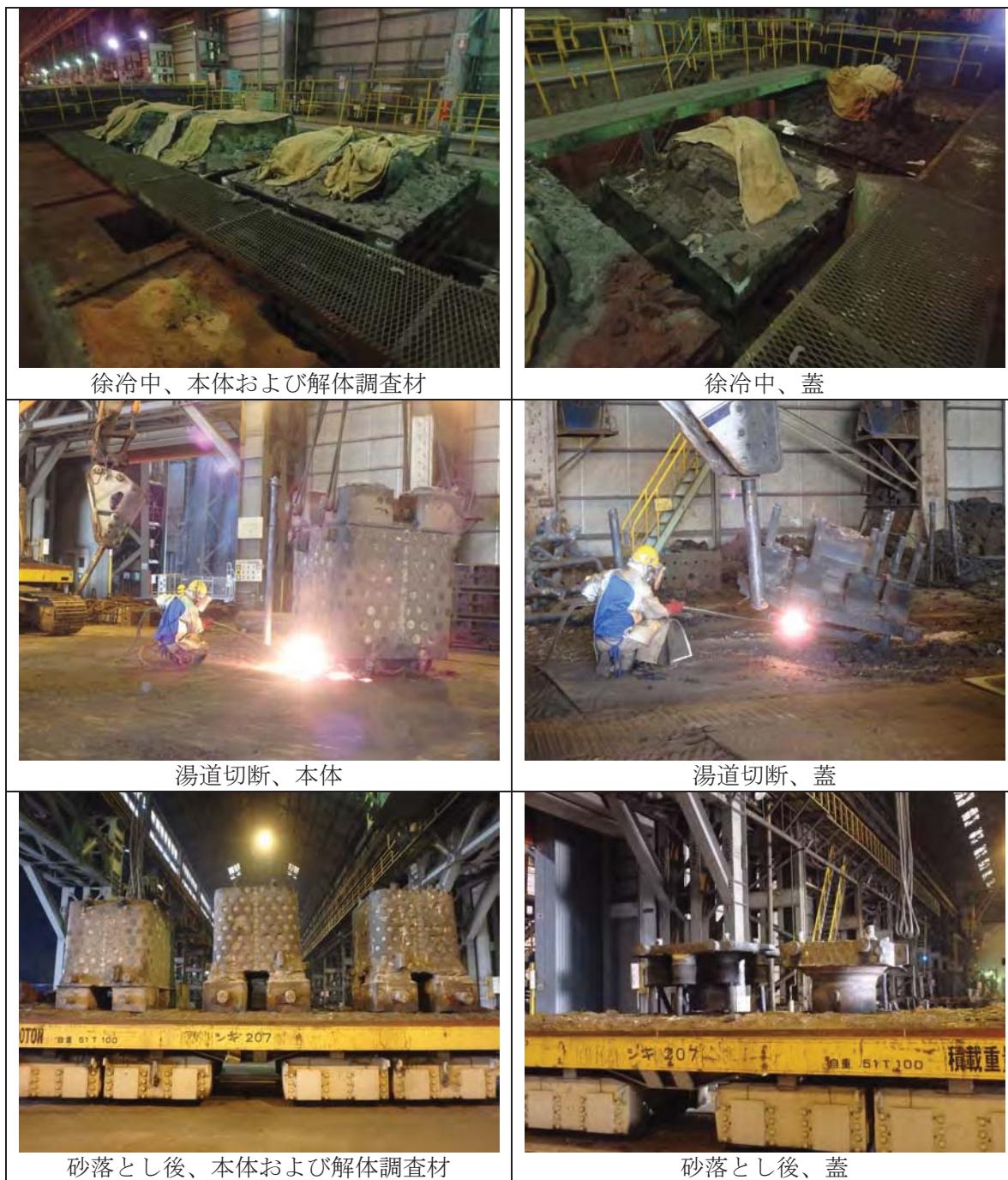
図 4.2.3-3 鑄放し、湯道切断、砂落とし状況
