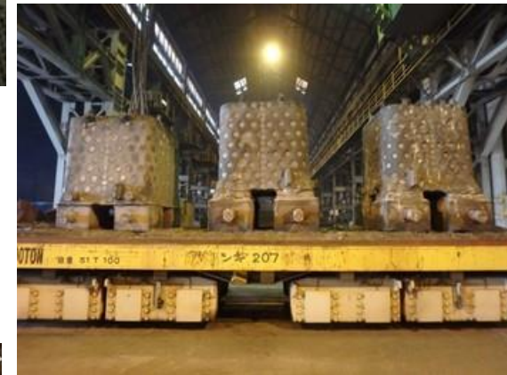
型枠取り外し後 (調質・熱処理前)
